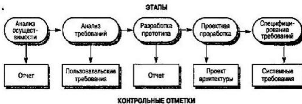
Рисунок 1. Этапы процесса разработки спецификации
